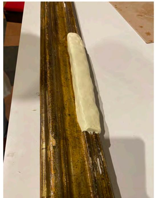
Infine è stato realizzato un positivo con un materiale epossidico (Araldite SV427 + HV427)
